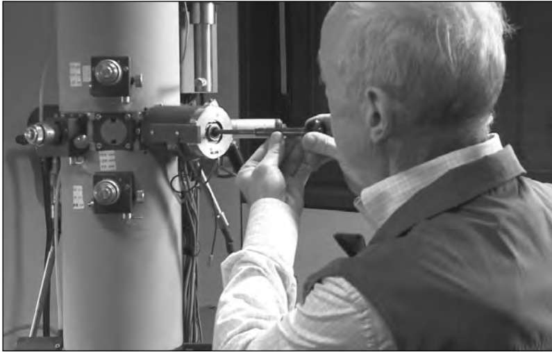
Figura 6.8 Operazione di inserimento di un portapreparati, come quello della Figura 6.7, all'interno del microscopio elettronico in trasmissione.
